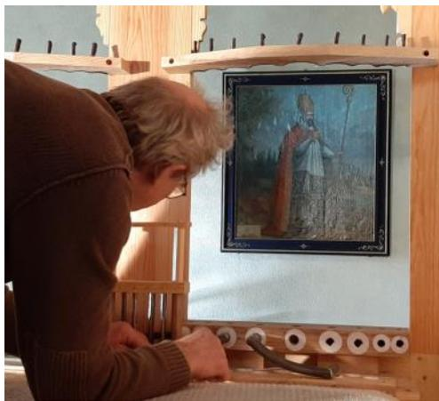
Bernard BOULAY notre facteur d'orgue œuvre dans le montage de l'orgue, sous la protection de St Cybard, patron de l'église que l'on aperçoit en arrière plan. Il coupe soude et met en place des tuyaux en plomb pour les tuyaux de « montre » ou « chanoines ».
